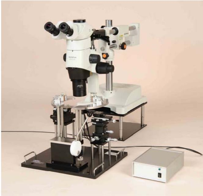
LED、レーザダイオード、VCSEL等の発光素子の光学特性をウェハレベルで測定するための電氣的、光学的プロービング装置です。
